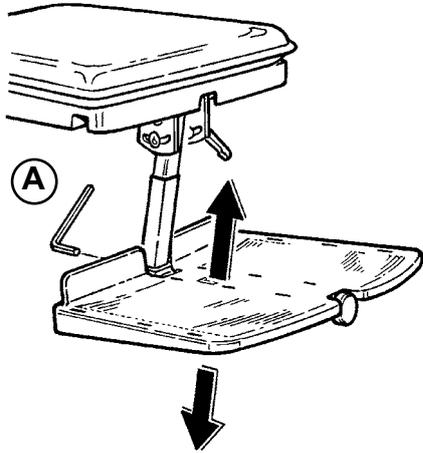
Le Wombat est livré de série avec un repose-pied. Il est possible de démonter le repose-pied, ce qui représente un avantage lorsque le Wombat est utilisé à hauteur de plancher. D'autre part, le repose-pied peut être réglé en hauteur. Utilisez la clé Allen 4 mm pour desserrer/reserrer (A).
