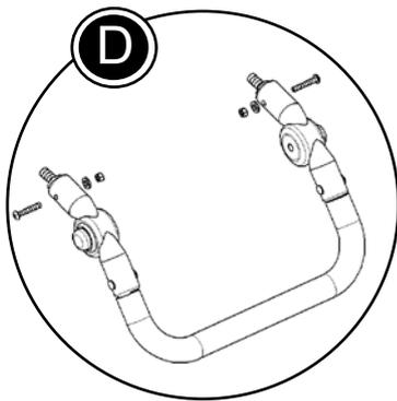
Placez les petits boulons (D) dans les trous extérieurs, par la barre de poussée et la douille. Le boulon et l'écrou sont placés à l'intérieur et fixés à l'aide de la clé Allen de 3 mm incluse.
