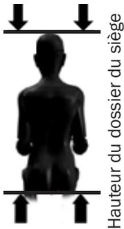
La hauteur du dossier du siège varie en fonction du type de fauteuil et la largeur du siège. Des extensions de support-tête sont disponibles lorsqu'une hauteur supplémentaire est nécessaire pour soutenir la tête de l'utilisateur. Pour déterminer la hauteur du dossier, mesurez la distance entre le siège et le haut des épaules (ou la partie supérieure de la tête). Fig. 22
