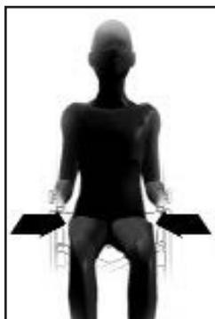
La corretta larghezza della seduta garantisce un posizionamento confortevole e previene l'insorgenza di problemi secondari. Per determinare la larghezza della seduta, misurare la distanza da un fianco all'altro. **Fig. 16**
