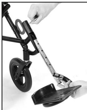
Trek aan de ring om de pin los te maken die de voetplaat op zijn plaats houdt. Beweeg de voetplaat omhoog of omlaag, stel de openingen weer op elkaar af en zet de pin erdoorheen terug in de buis. Afb. 54
