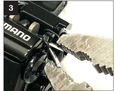
3. Retire el pasador de chaveta con unos alicates.
