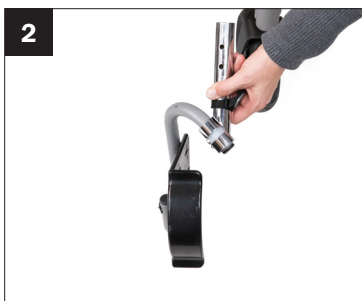
2. Retire el tubo de extensión del reposapiés de las sujeciones delanteras.
