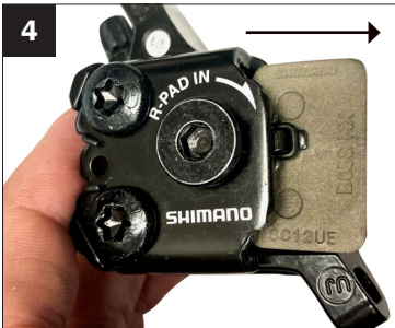
4. Para retirar las pastillas, empújelas a través de la pinza.
