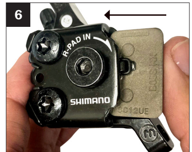
6. Vuelva a introducir las pastillas en el cáliper. Siga los pasos 3-1 a la inversa.
