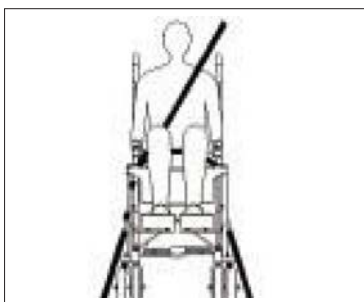
Alças de amarração dianteiras inclinadas para longe dos lados da cadeira.
