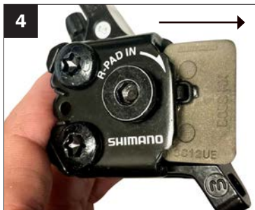
4. Para remover as pastilhas, empurre-as através da pinça.
