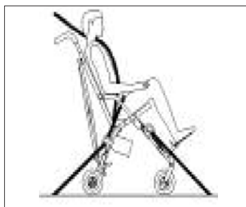
Posições corretas dos apoios dos cintos de ombro e abdominais e amarrações para cadeiras de rodas.
