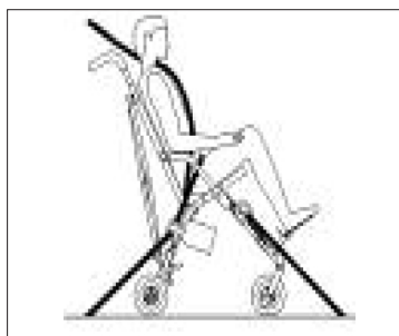
Posizioni corrette delle cinture di sicurezza addominale e diagonale e delle cinghie di ancoraggio della sedia a rotelle.
