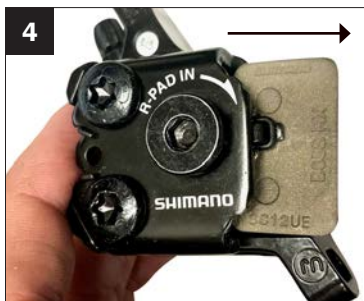
4. Pour retirer les plaquettes, poussez-les à travers l'étrier.
