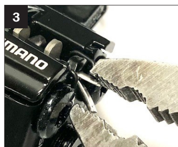
3. Retirez la goupille fendue à l'aide d'une pince.
