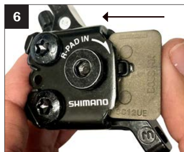
6. Insérez à nouveau les plaquettes dans l'étrier. Suivez les étapes 1-3 en sens inverse
