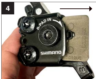
4. Pour retirer les plaquettes, les pousser à travers l’étrier.
