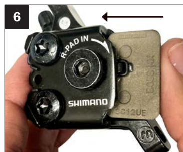
6. Réinsérer les plaquettes dans l’étrier. Suivre les étapes 3-1 en sens inverse
