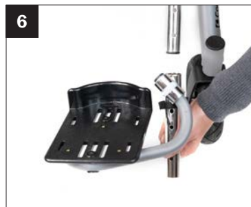
6. Remettre le tube d'extension du repose-pieds dans le cadre et le fixer à l'aide de la goupille d'arrêt.
