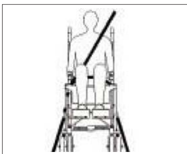
Voorste riemen zijn naar buiten gericht vanaf de zijkanten van de stoel.
