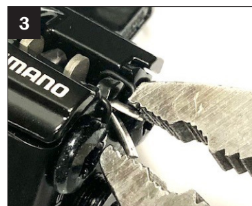
3. Verwijder de splitpen met een tang.
