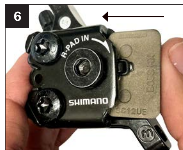
6. Plaats de remblokken terug in de remklauw. Volg stappen 1-3 in omgekeerde volgorde
