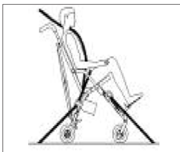
Juiste posities van schouder- en heupgordelbevestigingen en rolstoelbevestigingen.
