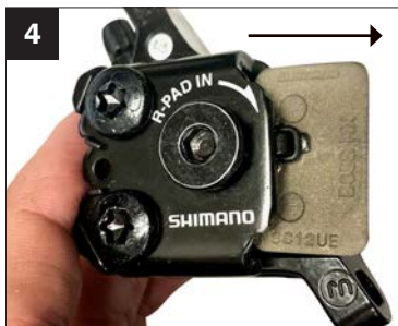
4. Om de remblokken te verwijderen, duwt u de remblokken door de remklauw.
