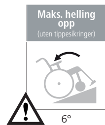
Stolen kan velte hvis hellingen bakover er større enn 6°. Bruk tippesikringer!
