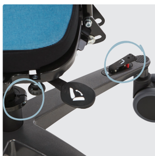
Regolazione dell'altezza a pedale con blocco di sicurezza e basculamento a leva sotto il sedile
