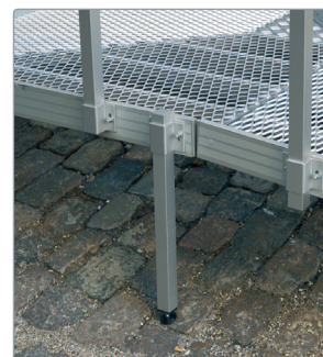
Benene kan forskyves/ vinkles i holderen og justeres med fingerskrue i foten
