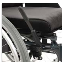
Broms med bromsspaksförlängare Bromsspaken kan vinklas framåt, för att underlätta vid sidoförflyttning.
