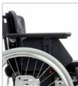
Omgekeerde lange armsteun, 36 cm, om opening te overbruggen.
