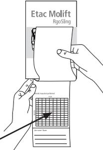
Kennzeichnen Sie das Etikett des Hebegurts mit einem Markierstift oder Locher mit dem Datum der durchgeführten Inspektion. Die nächste Inspektion ist innerhalb von sechs Monaten nach diesem Datum fällig.
