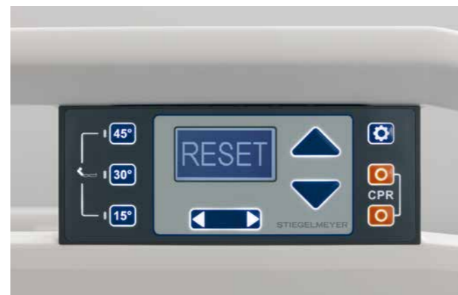
▲ Betjeningsnivået for teknisk personell i LCD-håndkontrollen og i kontrollpanelet tilbyr nyttige innstillinger til vedlikehold, feilanalyse og nullstillingsfunksjoner.
