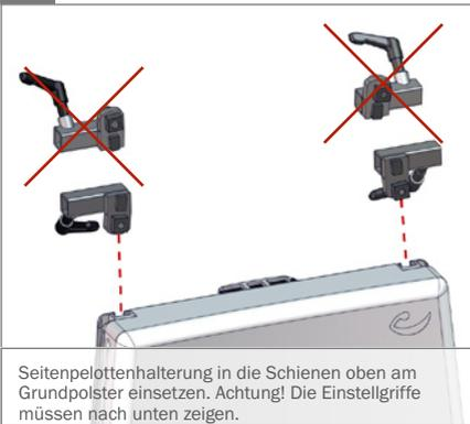
Seitenpelottenhalterung in die Schienen oben am Grundpolster einsetzen. Achtung! Die Einstellgriffe müssen nach unten zeigen.
