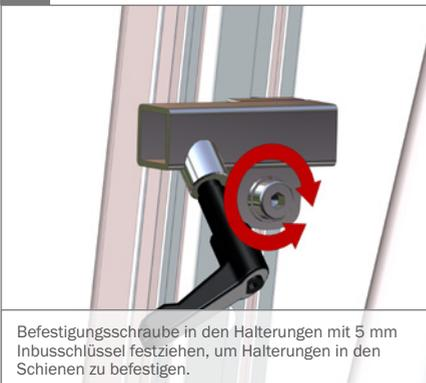
Befestigungsschraube in den Halterungen mit 5 mm Inbusschlüssel festziehen, um Halterungen in den Schienen zu befestigen.
