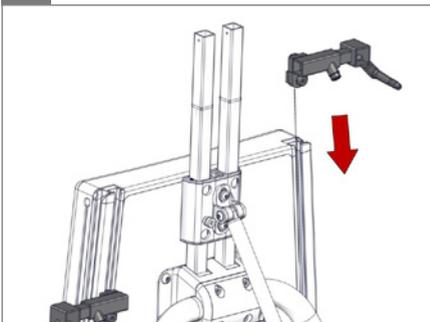
Halterungen in die Schienen an der Rückseite des Grundpolsters einsetzen.
