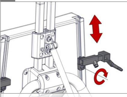
Halterungen mit 5 mm Inbusschlüssel montieren. Achtung! Parallele Montagehöhe der Halterungen sicherstellen.
