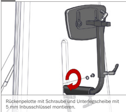
Rückenpelotte in die Befestigungsöffnung am Grundpolster einsetzen.
