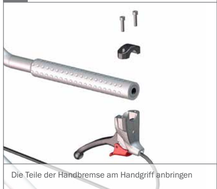
Die manuellen Bremsen mit einem 4-mm-Inbusschlüssel auswechseln
