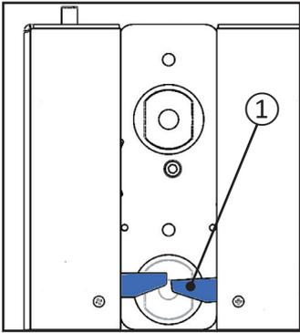
Le boulon de verrouillage ② **no** debe ser visible cuando se desconecte el acoplamiento.
