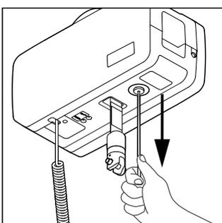
Mantenga pulsado para iniciar el descenso. Manténgalo pulsado hasta que el usuario haya descendido y pueda desengancharse de la percha.
