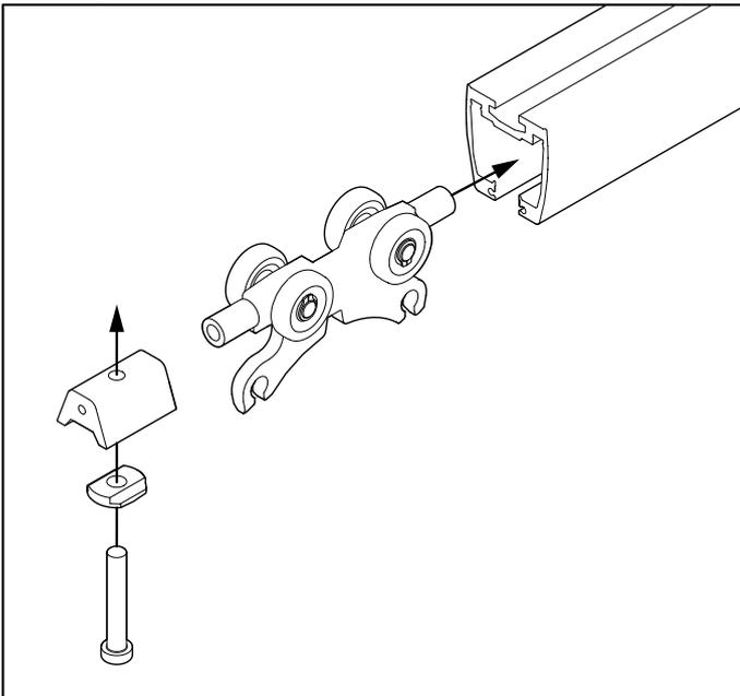
Retire el tope e inserte el carro en el raíl. Vuelva a montar el tope y asegúrese de que está fijado de manera segura.
