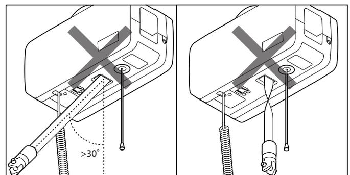
Si el elevador no responde al botón «arriba» del mando, puede que se deba a que el ángulo de la correa de elevación es demasiado inclinado, o a que la cinta de elevación está doblada y el sensor está activado.
