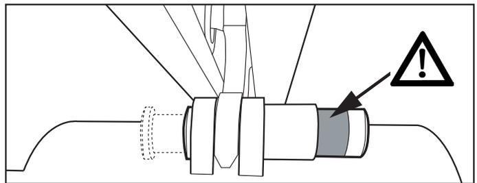
Tras la instalación, compruebe que los botones de los dos puntos de conexión están completamente en su sitio y muestran claramente el color verde.
