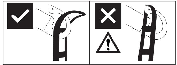
El diseño de gancho de la percha evita que la eslinga se desate involuntariamente cuando esté correctamente montada.
