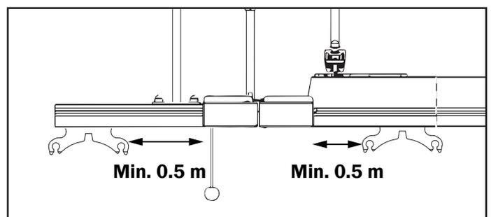
Tire de la polea hacia abajo hasta el tope. Escuchará un sonido que confirma la desconexión.
