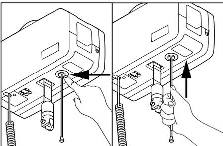
Empuje con el dedo o utilice el tubo en el cable para empujar el botón hacia atrás y reiniciar la parada de emergencia.
