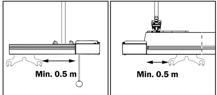
Empuje el raíl transversal hacia el raíl fijo, de modo que las unidades de acoplamiento de transición se conecten, y oiga un sonido.
