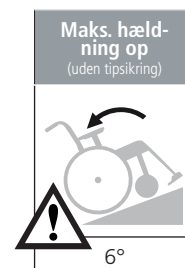
Stolen kan vælte, hvis den bagudrettede hældning er større end 6°. Anvend tipsikring!
