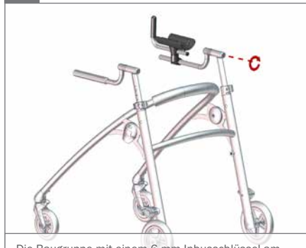
Die Baugruppe mit einem 6-mm-Inbusschlüssel am Rahmen befestigen
