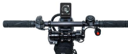
Tetra uitvoering (stuur naar u toe bewegen is gas geven, stuur van u af bewegen is remmen)
