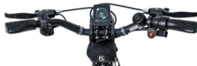
Standaard bediening duimgas rechts
