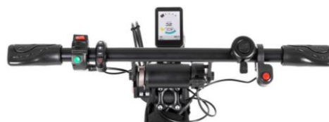
Tetra uitvoering (stuur naar u toe bewegen is gas geven, stuur van u af bewegen is remmen)
