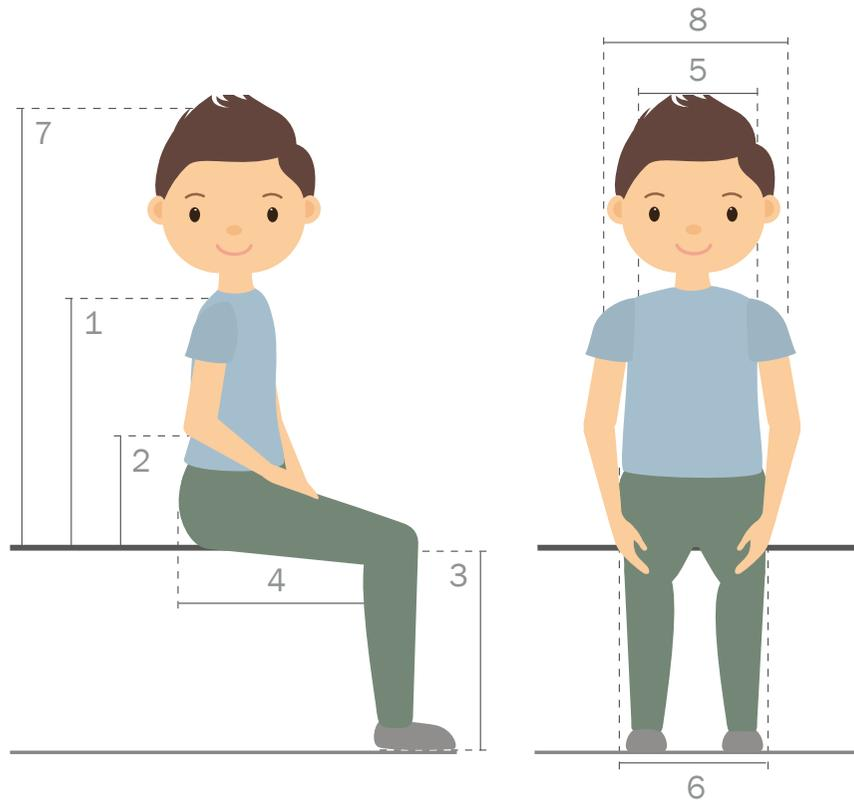
Dies ist eine einfache Anleitung, um sicherzustellen, dass der Stuhl für den Benutzer richtig konfiguriert ist. Um genau zu messen, muss der Benutzer auf einer festen, flachen Oberfläche liegen, wobei Hüfte, Knie und Knöchel einen 90-Grad-Winkel bilden müssen.
