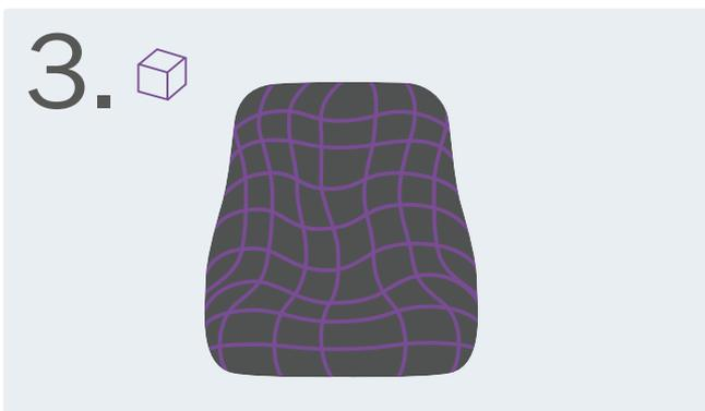
Die Rohdaten des Scans werden mit Hilfe der vorhandenen Software nachbearbeitet und wichtige Zusatzinformationen, wie Schnittkanten und Positionen für Gurtschlitz oder Zubehör, eingefügt.
