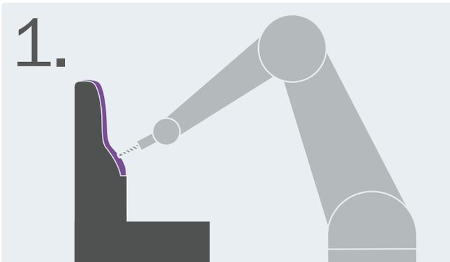
1. Basierend auf dem eingesendeten 3D Scan fräst ein Roboter ein exaktes Negativ-Modell aus Polyethylen. Über diesem wird anschließend im Tiefziehverfahren die finale Kunststoff-Schale inkl. Polsterung gezogen.
