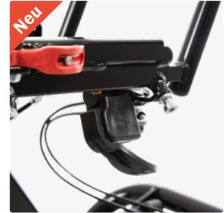
**Zentrale Feststellbremse (Handbedienung)**
