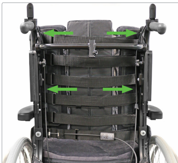
Wire for rygvinkling og sædevinkling afkortes.
