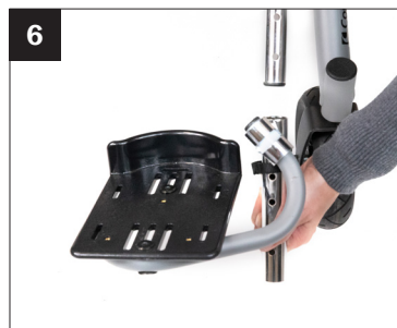
6. Umieść rurę przedłużającą podnóżka na ramie i zabezpiecz trzpieniem ustalającym.
