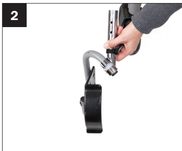
2. Wymontuj rurę przedłużającą podnóżka z przedniej platformy.
