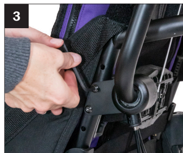
3. Jeśli wymagana jest dodatkowa regulacja wysokości, odkręć śrubę mocującą tylny pozycjoner do ramy.
