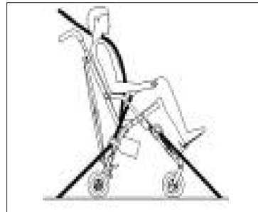
Korrekte Position des Schulter- und des Beckengurts sowie der Rollstuhl-Zurrgurte.
