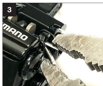
3. Entfernen Sie den Splint mit einer Zange.
