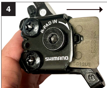
4. Um die Bremsbeläge zu entfernen, schieben Sie sie durch den Bremssattel.
