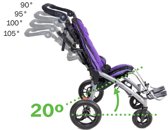
Coaster mit 20°-Sitzwinkel und verstellbarer Rückenlehne
