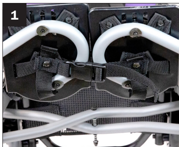
1. Pour fixer les repose-pieds, attachez la sangle gauche et la sangle droite ensemble.
