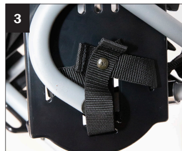
3. Boulonner la sangle sous le repose-pieds à l'aide d'un tournevis cruciforme.
