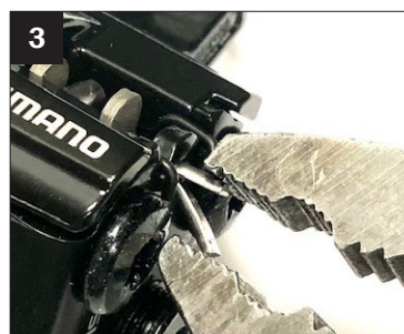
3. Retirer la goupille fendue à l'aide d'une pince.
