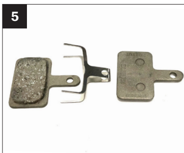
5. Remplacer les tampons.
