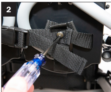
2. Pour retirer la sangle de fixation du repose-pieds, dévissez la vis située sous le repose-pieds à l'aide d'un tournevis.
