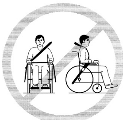
Bild 4: Alla bälten ska ligga så nära kroppen som möjligt och inte hållas ifrån kroppen av komponenter, t.ex. armstöd eller hjul.
