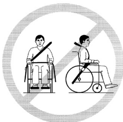
Figura 4: Os apoios tais como suporte de antebraço e rodas não devem ser mantidos fora da cadeira de rodas.
