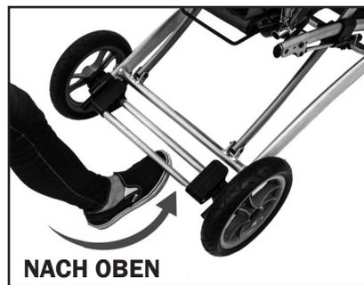
Abb. 6 Arretierung lösen
