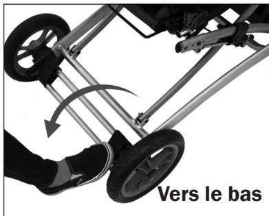
Fig. 5 Verrouillage
